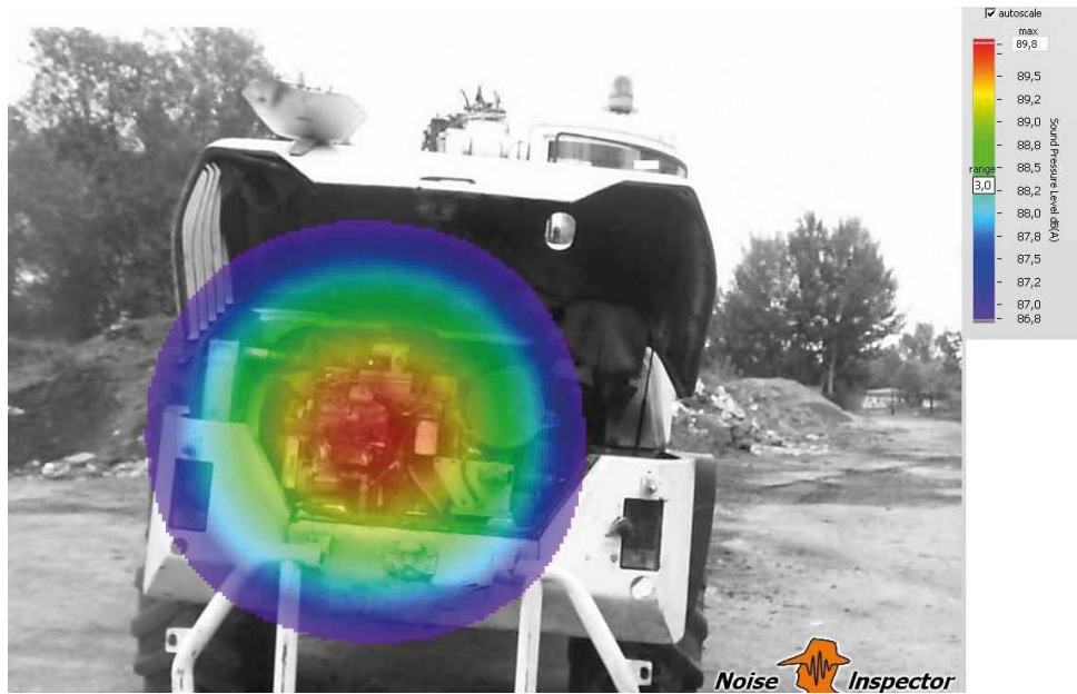
Rys. 8: Lokalizacja źródeł hałasu w koparko-ładowarce – Odstłonięta osłona silnika.
