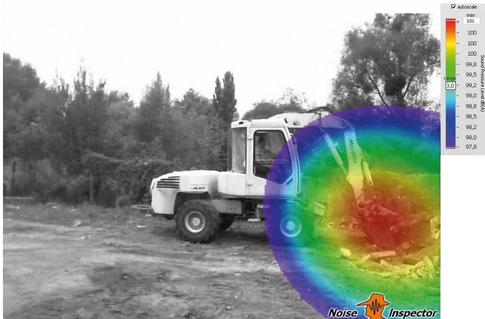
Rys. 7: Lokalizacja źródeł hałasu w koparko-ładowarce – Załadunek urobku.
