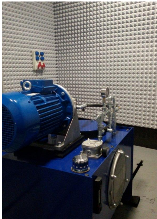
Rys.1: Obiekt badań akustycznych w komorze semi-bezechowej
