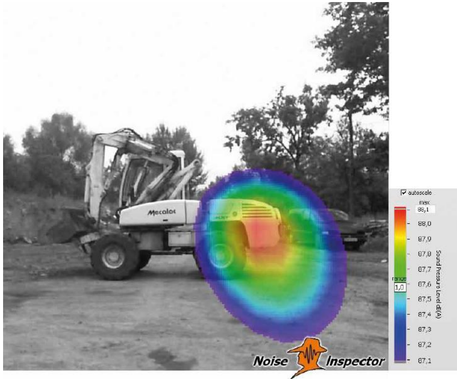
Rys. 6. Lokalizacja źródeł hałasu w koparko-ładowarce – Pomiar kamerą akustyczną
